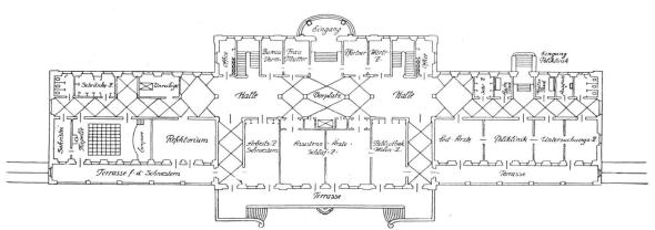
Entwurf zum Bürgerspital Solothurn. — Grundriss des Erdgeschoss. Architekten: Saager & Frey, Biel.
