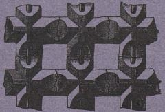
empfiehlt Drahtziegelgewebe zu Verkleidungen, Decken, Wänden, Böden, Gewölben, Einfriedigungen und Ummantelungen
