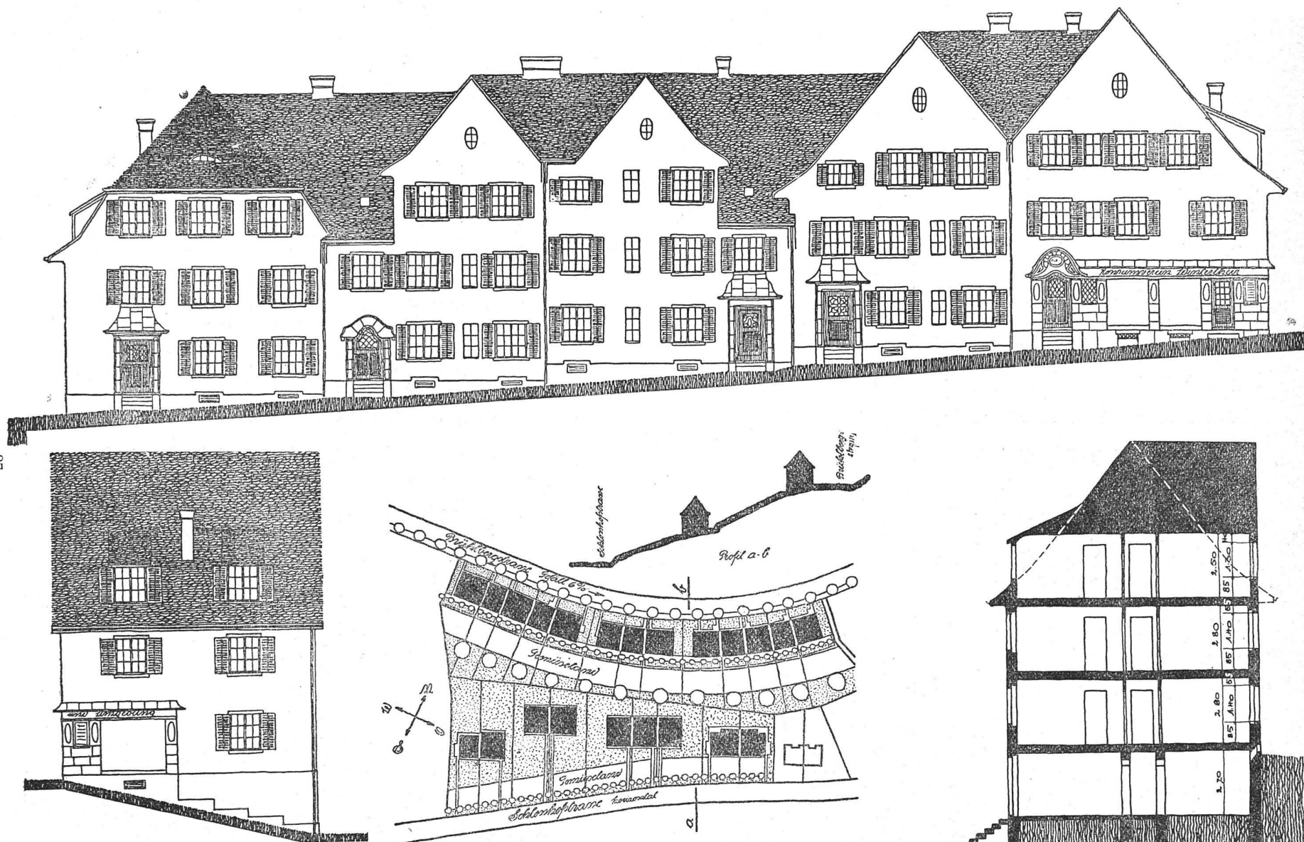
Zur Ueberbauung des Brühlbergareals in Winterthur — Architekten B. S. A. Fritsch & Jangerl in Winterthur Geometrische Ansicht — Ansichten und Querschnitt der Fünfhäusergruppe 1:200 — Lageplan und Querprofil 1:2000
