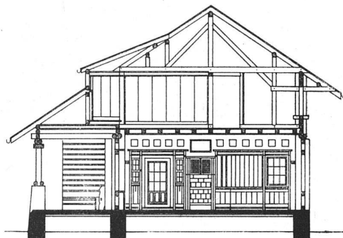
Restaurant Robbi auf der Oberalpina bei St. Moritz. — Giebel- und Querschnitt. — Maßstab 1 : 200
