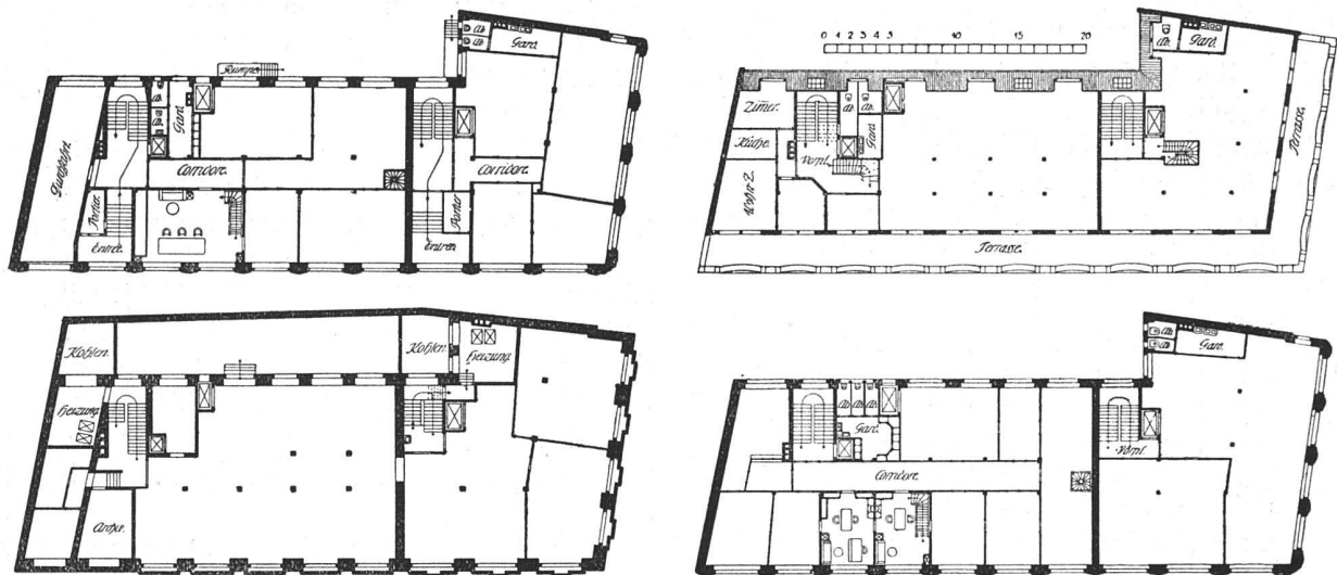
Das Geschäftshaus Zürcher, Niederer & Cie. in St. Gallen. — Grundrisse von Keller, Erdgeschoß, erster Stock und Dachgeschoß. — Maßstab 1 : 600
