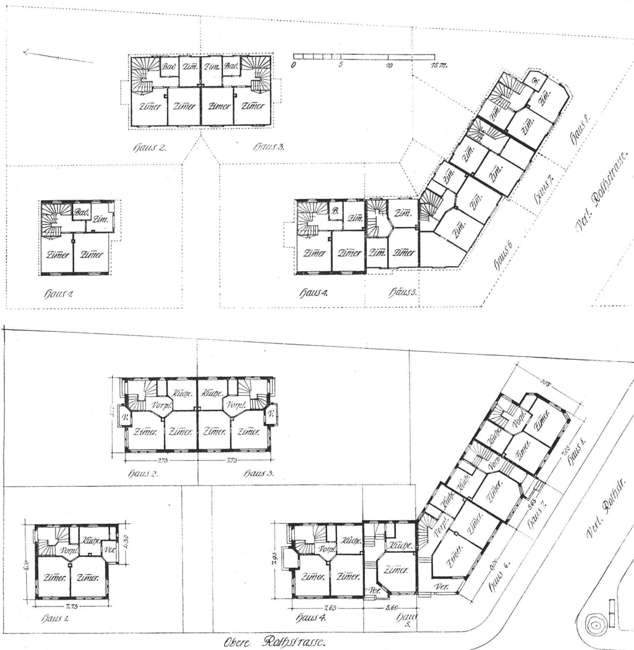
Gruppe von Einfamilienhäusern an der oberen Rothstrasse in Zürich IV. — Grundrisse vom Erdgeschoss und Oberstock. — Maßstab 1:400. (Bergl. S. 153, 154)
