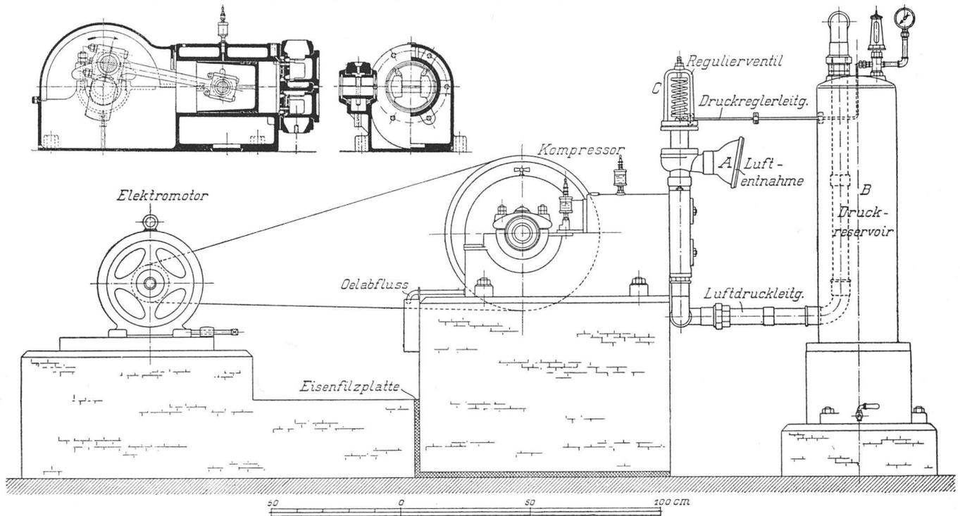
Abb. 24 und 24a. Entstaubungsanlage von A. Borsig, Tegel/Berlin, mit Kompressor. — Ansicht und Schnitt. — Maßstab 1:20
