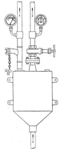
Abb. 22. Vakuum-Entstaubungs-Apparat „Gnom“ für Druckwasserbetrieb der Firma F. & C. Ziegler, Schaffhausen. — Maßstab 1:20
