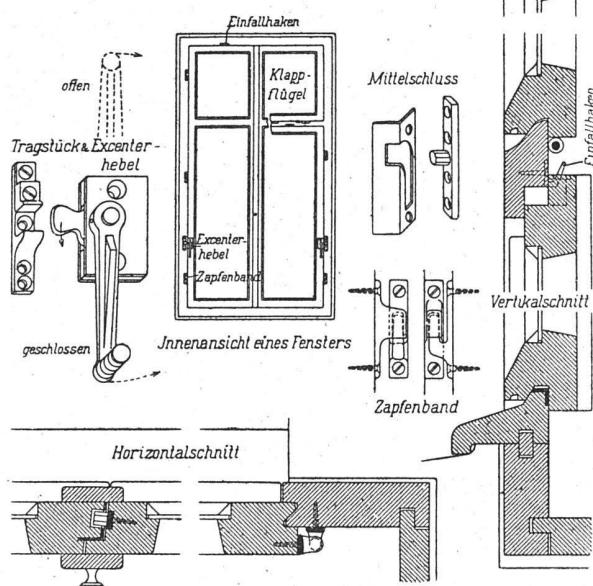
Der dichte Abschluß wird, wie aus der obenstehenden Zeichnung ersichtlich ist, dadurch erzielt, daß der Fensterflügel in geschlossenem Zustand unten, nach außen und nach innen übergreifend, mit seinem ganzen Eigengewicht auf einem kräftigen Holz aufruht. Zur Öffnung des Flügels, der dabei über diesen Holz gehoben werden muß, dient
