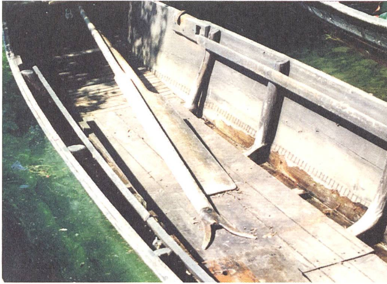
10 Der letzte Naturspantenweidling von Hans Hartmann, gebaut 1967, Zustand 1990. Besitzer: John P. Naegeli. Foto: Eduard Joos, 1990.
