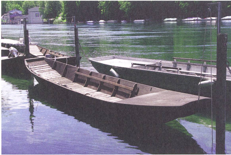
16 Sperrholzweidling Typ Mändli, daneben ein Aluminiumfährboot. Foto: Eduard Joos 2020.
