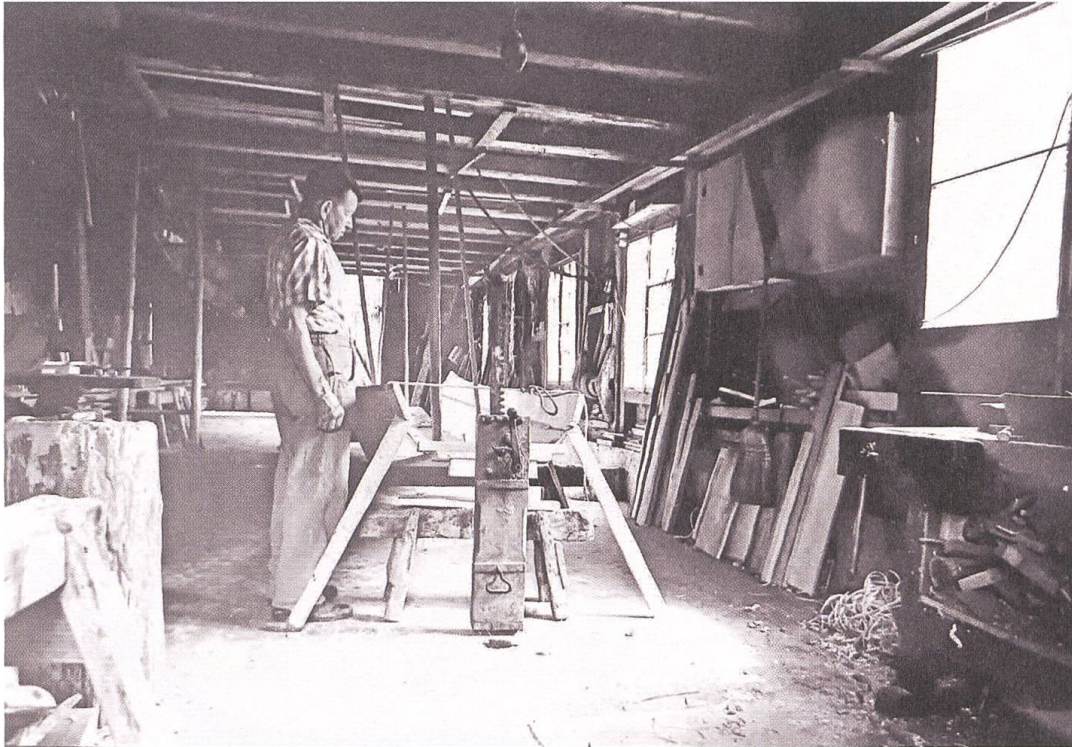
9 Der Weidlingbauer Hans Hartmann in seiner Eglisauer Werkstatt. Im Vordergrund ein Wagenheber, womit der Weidlingsboden hochgewuchtet wurde. Foto: Silvia Zwinggi, Eglisau, 1988.
