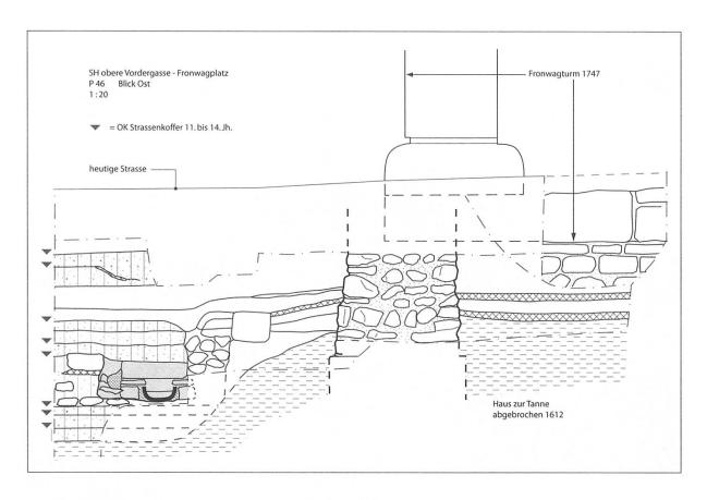
Abb. 5: Profil der ältesten mittelalterlichen Wasserleitung der Schweiz in den Strassenkoffern des 11.–14. Jahrhunderts am Fronwagplatz.
