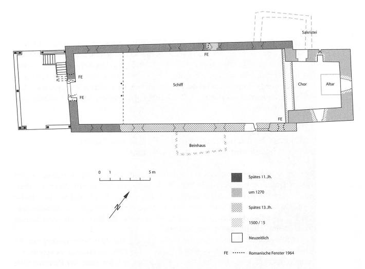
Abb. 4: Grundriss der Kirche Lohn mit der baugeschichtlichen Analyse.
