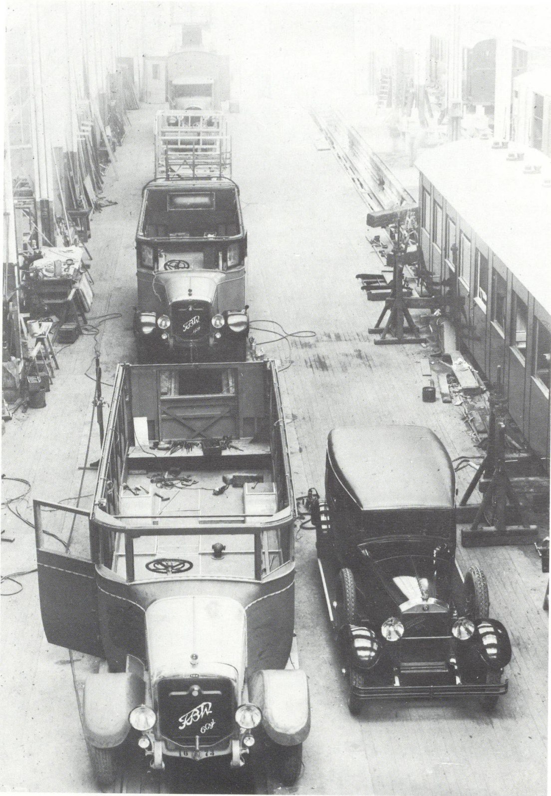
Bild 8 So sah es am 11. Juni 1929 in der Halle 3 der SIG-Waggonfabrik aus. Links eine Montagelinie von SIG-Postautomobilen mit FBW-Motoren. Vorne rechts einer der legendären MARTINI-SIX-Direktionswagen. Rechts Fertigmontage von Eisenbahnwagen für die SBB. Eine echte Diversifikation «à la carte»
