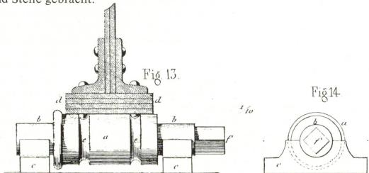
Die Walzen a waren von Schmiedeisen, hatten 4 ½ Zoll im Durchmesser und ruhten mit Zapfen b von 3 Zoll Länge in gusseisernen Lagern c. Auf den Walzen lag die untere Flantsche d des Gitters mit dem flachen
