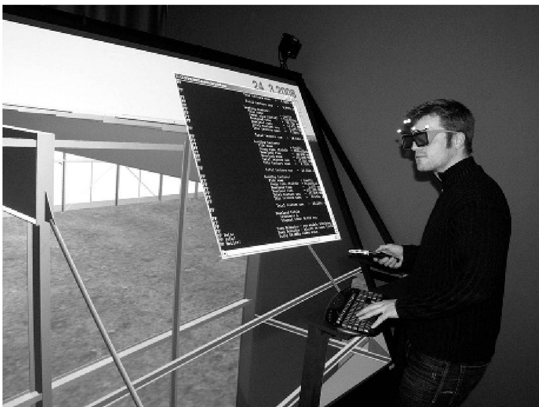
Abb. 1 und 2: Virtual Reality Lab am Institut für 4D-Technologien, FHNW. Die Kombination von interaktiver Trackingtechnologie, Echtzeitrendering und stereoskopischer Rückprojektion stellt eine Simulationsumgebung bereit, die den Besucher in eine künstliche Welt eintauchen lässt.
