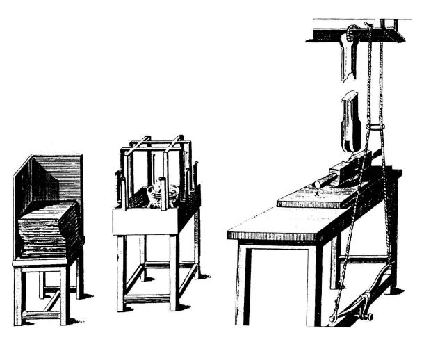
Abb. 1: Links: Gestell für trockenen Karton, mitte: Leimtopf mit Heizvorrichtung, rechts: Glättevorrichtung für geleimten Karton.
