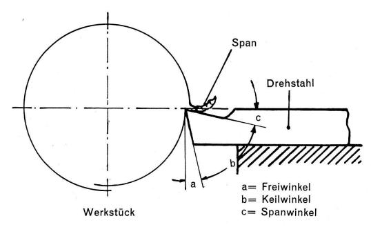
Abb. 13. Mit dieser Skizze sei den Lesern ein Drehstahl mit den drei wichtigsten Winkeln vorgestellt, wie sie für das Metalldrehen sein müssen. Durch Abschleifen können die Winkel a und c verändert werden, so dass der Keilwinkel b grösser oder kleiner wird. So kann dieser dem Material des Werkstückes und dessen Härte angepasst werden.
