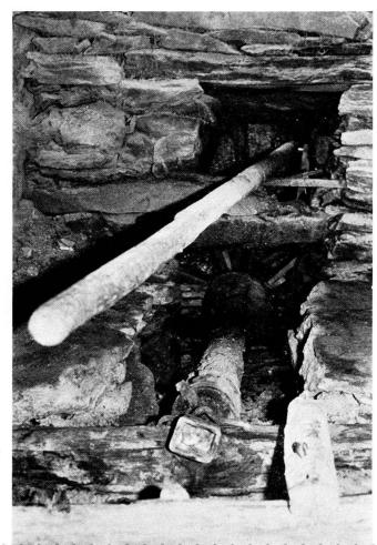
Abb. 2. Durchsicht durch die Hüttenwand auf die kleine Turbine. Von dieser führt die Drehbankachse in den Raum. An deren Ende der rechteckige konische Becher für die Aufnahme der Keule. Oben die Regulierstange für die Betätigung des Schiebers.
