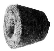
Abb. 8. Als Rest von der innersten Schüssel bleibt noch der Kern. Vorn die zuerst eingedrehte Zentrierung und hinten der abgebrochene Zapfen.
