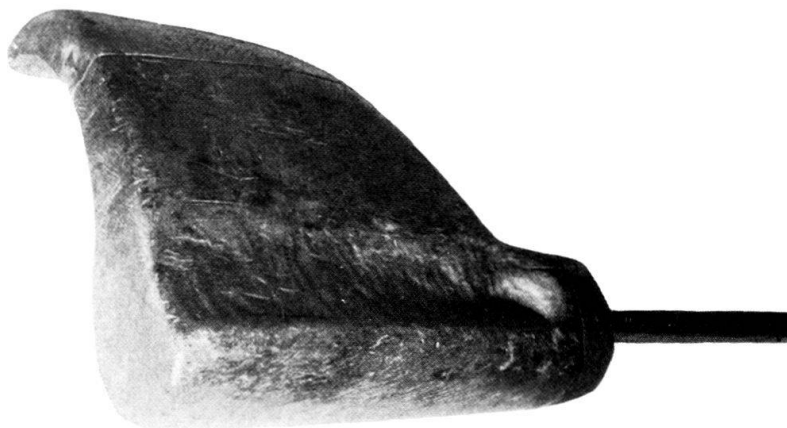
Abb. 14. Das legno per ferro di fondo von seiner Unterseite. Die halbrunde Kerbe kommt auf den Oberschenkel des Drehers zu liegen. Im Besitz des Schweiz. Museums für Volkskunde, Basel.
