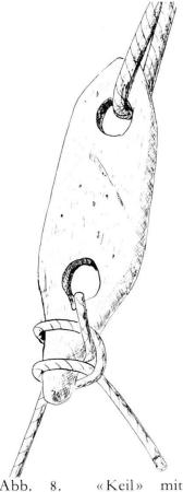
Abb. 8. «Keil» mit Schlinge. Der Spannstrick dünner als der Haltestrick, weshalb er kein grösseres Loch benötigt. Inv. Nr. 6166. L = 27 cm, Buche.
