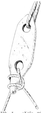
Abb. «Keil» mit 8. Schlinge. Der Spannstrick dünner als der Haltestrick, weshalb er kein grösseres Loch benötigt. Inv. Nr. 6166. L = 27 cm, Buche.
