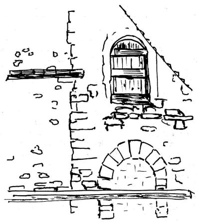
Abb. 5. Hinterwand des Heustalles Haus Nr. 168. Rechts mittelalterlicher Wohnturm mit vermauertem ursprünglichem Zugang zum Untergeschoss (Keller Haus 167). Wegen des abfallenden Geländes liegt dieser höher als der Keller von Haus 168. Darüber Zugang zum zweiten Turmgeschoss, das dem Haus 168 als Vorratsraum (Chamineda) diente. Die Balkenlage entspricht der Höhe des Heubodens bzw. des Gemeinsamen Sulèrs.
