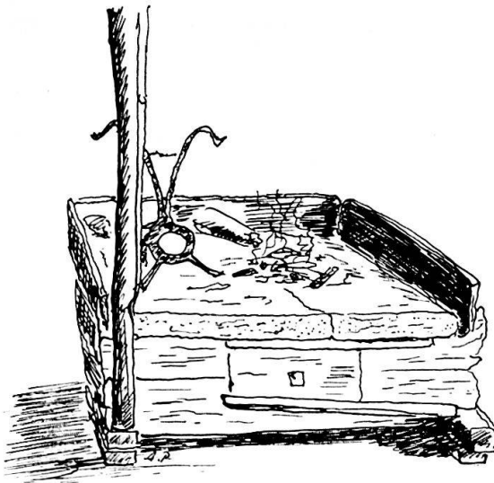
Abb. 2. Freistehender Herd in Lanersbach (Tirol). Sockel aus gewetteten Balken und Fach zum Warmhalten; steinerne Feuerplatte, mit gestellten Steinplatten umrandet, Pfannenknecht. (Nach einer Phot. von Wopfner).
