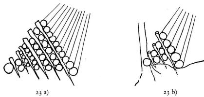
Abb. 23. a) Grosse Hebaufwand, Verlege- oder Sammelstelle arca, archa. b) Kleinere arca auch spatla oder archetta, fratga genannt. c) Zwischen- oder Schlußstück eines Geleits mit Bremsklöppel, Auswurfstelle und nachfolgender spatla und arca. Das Holz geht dann zur Sammelstelle a mantun, muntanar.
