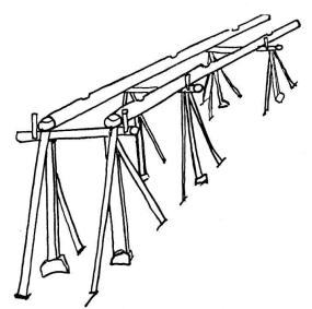
Abb. 11. Unterbau eines Bock- oder Brückengeleits.
