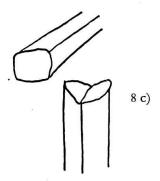
Abb. 8. a) 1. Banchina mit Abplattung. 2. Stütze. 3. Stützstein. 4. Bockträmel. b) 1. Banchina, traversal mit Ausbuchtung. 2. Pfosten mit geissfussförmiger Ausbuchtung pecaura. 3. Tragträmel, etwas abgeplattet subigia. 4. Holznagel darschun. c) Stütze mit Geissfuss pecaura.
