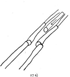
Abb. 27. a) b) Bremszange im Geleit eingebaut. Sie kann bremsen, aber auch über Hindernisse zum nächsten Geleitstück werfen.
