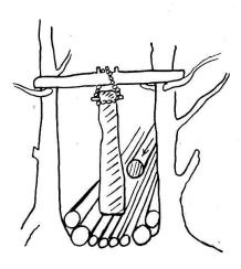
Abb. 29. An Bäumen oder Gerüsten aufgehängter Baumklöppel als Bremser und Warner.
