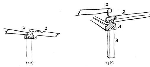
Abb. 13. a) Haltung mittels eingeschlagener Holznägel allein, stumpfe Verbindung. b) Befestigung mittels Überplattung, Dübelung und Einbuchtung. 1. banca. 2.subigia. 3. petga.
