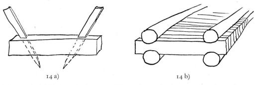
Abb. 14. a) Geleitbahnen in Form von Wagenkissen mit Hörnern sutga, plumatsch cun corns, cornera. b) Geleitbahn in Form von Bachbrücken, sogenannte supias de Rein.
