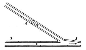
Abb. 1. Sammelgebiet oben im Einzugsgebiet. 1. Eines der Fallgeleite, mit immer genügender Neigung und «Schuss». 2. Flanken- oder Talgeleit, mit oft geringer Neigung. 3. Hauptgeleit.
