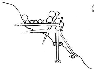
Abb. 6. Geleit mit seitlichem Unterbau und verstärkter Aussenwand.
