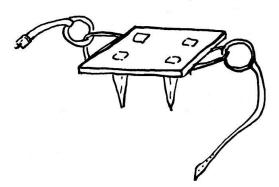
einen Halt, jedoch besteht bei ihnen die Gefahr, dass man leicht an Stauden, Grasböschen oder selbst am andern Hosenbein hängen bleibt, was einen tödlichen Sturz zur Folge haben kann. Auch in Obwalden sind diese aufgenagelten Eisenspitzen üblich. Diese werden jedes Jahr wieder neu geschliffen.
