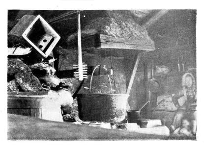
Käsekessel und Drehvorrichtung  $Fig.\ 18$
