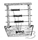
dicks Brittli, drin ist es viereggigs Trögli (ca. 5 cm.) usgschnitten und im sälba der Lengi nah en Isadrath. Mit zwei Füess im Brittli befestigt ist en eifachi Ramma midema Isastengli in der Mitti. An dassälb würd der Spuelen mid dem Garn angschloffen. Von dört wärdend z'mal dry Fäden mid dä
