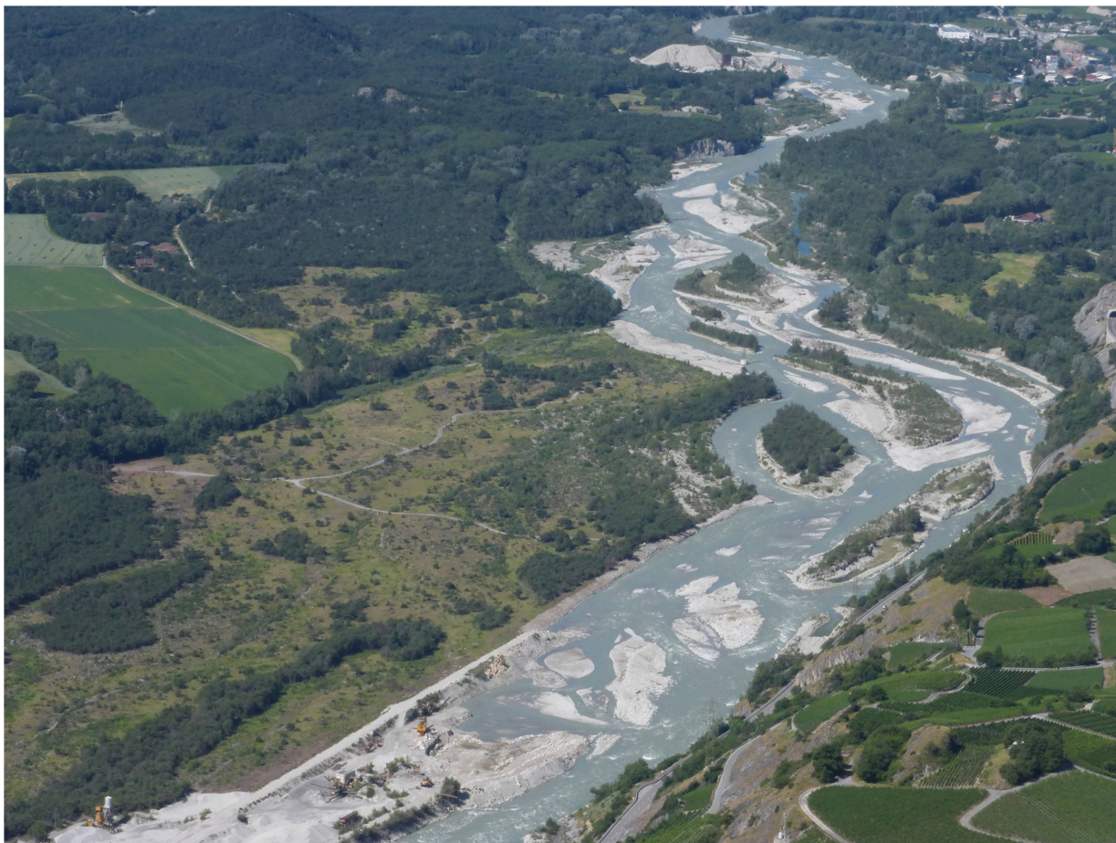
Figure 1. Le Rhône de Finges en cours de revitalisation depuis 1994: démantèlement de la digue de rive gauche et de la gravière au premier plan, apparition d'îlots favorables à Myricaria germanica (13.6.2015, par moyennes eaux).
