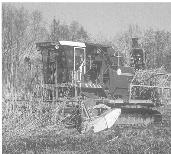
Figure 4. Elbotel est une faucheuse prototype spécialement mise au point pour l'entretien de la Grande Cariçaie. Elle est équipée d'un peigne de coupe de 6,2 m de large, d'un train de chenilles de 15 m 2 de surface portante et d'une partie supérieure pouvant pivoter à 180°, ce qui lui permet de faucher dans les 2 sens sans manoeuvrer les chenilles en bout de ligne. 22 balles de paille, d'un poids moyen de 300 kg, peuvent être stockées sur les passerelles latérales pour être évacuées du marais. Le rythme de travail est en moyenne d'un hectare par jour. Photo: coll. Grande Cariçaie.
