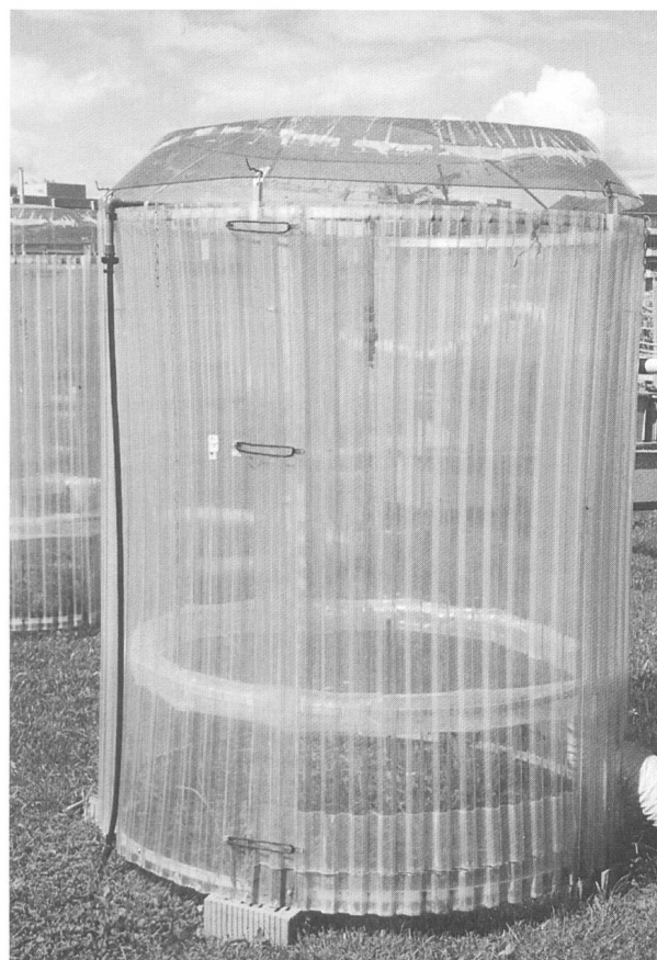
Figure 1. Chambre de fumigation externe à ciel ouvert
