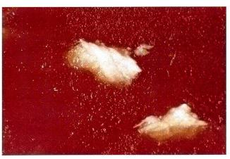
Abbildung 2: Stereomikroskopische Darstellung der weisslichen Einlagerungen
