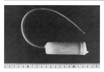
Abbildung 2: Temperatursender mit Antenne
