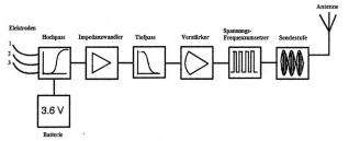
Abbildung 3: Blockschema der Schaltung des Herzfrequenzsenders
