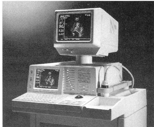
**Technik:** Cine-Loop, div. Bildspeicher, elektronische Fokussierung, programmierbare Presets, einfacher Software-Upgrade durch Cartrige-System, EKG-Modul, umfangreiche Mess- und Auswertungsprogramme, TM/M-Mode, robuste, multifrequente Annular-Array-Schallköpfe mit kleiner Auflagefläche für alle Anwendungsbereiche (2.5/3.5 MHz, 3.5/5.0 MHz, 5.0/7.5 MHz, 7.5/10 MHz), SW/Color-Doppler Option usw.
