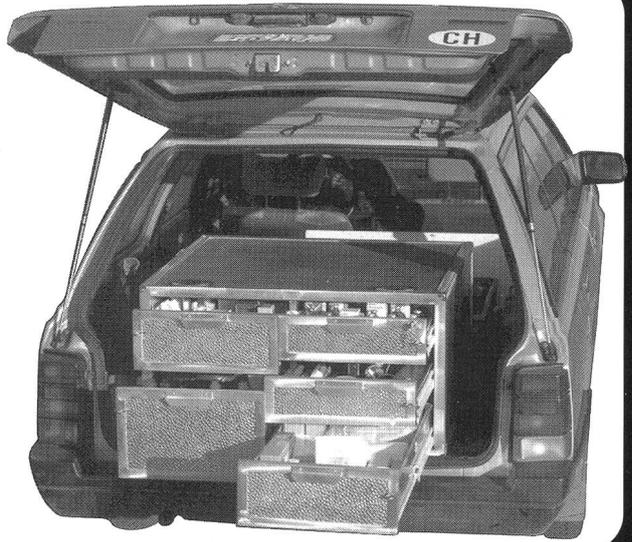
Wärme, Verschmutzung und unerlaubtem Zugriff. Robuste Ausführung aus Aluminium mit Innenwand-Isolierung, Rollschubladen (eine Schublade abschliessbar). Die Kramer Autoapotheke passt in jeden Kombi oder Jeep. Ausbaufähig mit verschiedenen Modellen.
