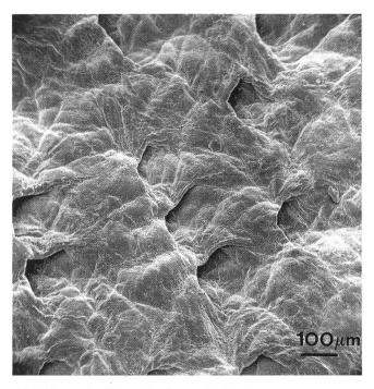
Abbildung 5: Unverändertes Leder im Rasterelektonenmikroskop
