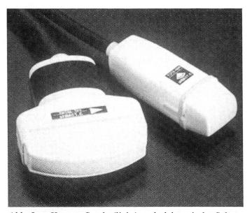
Abb. 5a: Konvex-Sonde (links) und elektronische Sektorsonde (rechts). Durch Krümmung der ebenen Auflagefläche der Linearsonde ist eine Konvex-Sonde entstanden. Die Auflagefläche der elektronischen Sektorsonde ist noch kleiner, aber eben.
