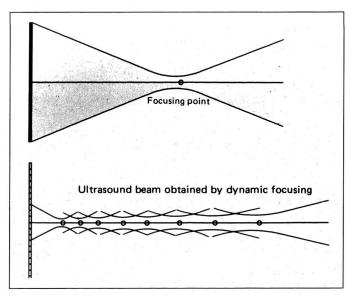
Abb. 6: Schematische Darstellung der Fokussierung des Schallstrahles.
