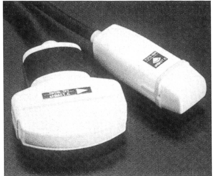
Abb. 5a: Konvex-Sonde (links) und elektronische Sektorsonde (rechts). Durch Krümmung der ebenen Auflagefläche der Linearsonde ist eine Konvex-Sonde entstanden. Die Auflagefläche der elektronischen Sektorsonde ist noch kleiner, aber eben.
