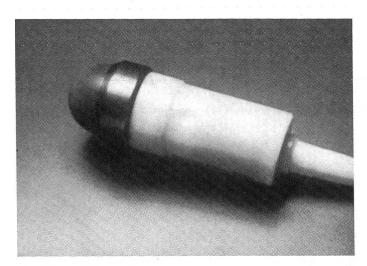
Abb. 1: Ultraschallsonde (mechanische Sektorsonde). Im kuppelförmigen Teil links sind die Kristalle angeordnet, welche die Schallwellen aussenden und die zurückgeworfenen Echos wieder empfangen. Ein Elektromotor im hellen Gehäuse rechts versetzt die Kristalle in Rotation oder Oszillation.
