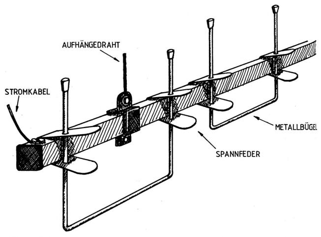
Abb. 1: Kuhtrainer. Gezeigt sind nur 2 Bügel. Der Aufhängedraht ist gegenüber dem Vierkantrohr isoliert. Durch Zusammendrücken der Spannfedern lassen sich die Bügel lösen und in der Höhe verstellen. Am Aufhängedraht können Rohr und Bügel als Ganzes hochgezogen werden. Der Kuhtrainer befindet sich dann ausser Reichweite der Kühe.
