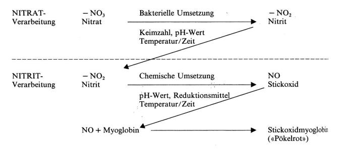
Abb. 1 Vereinfachter Reaktionsmechanismus der Pökelfarbbildung
