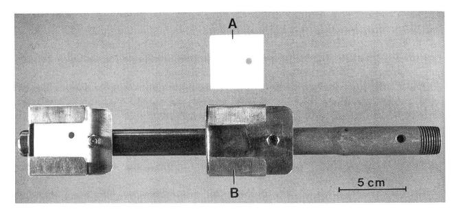
Abb. 1 A: Keramikplättchen (40 × 40 mm, Dicke 5 mm) als Keimträger. B: Halterung für Keimträger an Eisenrohr, das durch Anschrauben weiterer Teile verlängert werden kann. Linke Halterung mit eingeführtem und befestigtem Keimträger.
