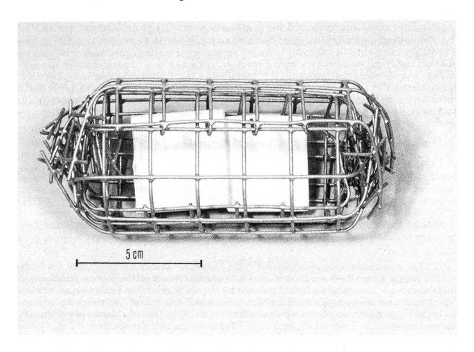
Abb. 2 Keimträger in einem Drahtkäfig
