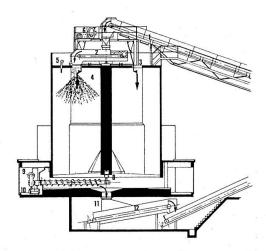
Abb. 14 Beispiel einer Schlammkompostierungsanlage (Feuchtrotte)
