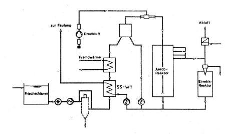
Abb. 11 Aerob-thermophile Teilfermentation mit anschliessender Faulung, System Roediger-Aeromethan
