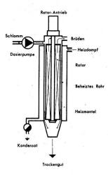
Abb. 17 Detail eines Dünnschichtverdampferelementes
