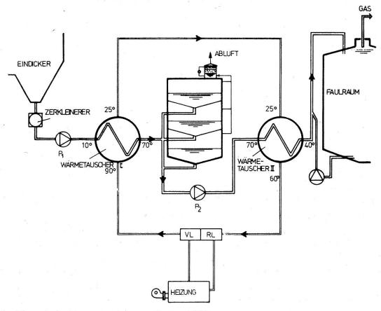
Abb. 6 Thermische Vorpasteurisierung System UTB
