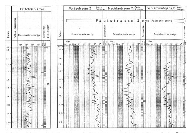
Abb. 3a Gehalte an Enterobacteriaceen im Frischschlamm und in der Faulstrasse 2 (ohne Pasteurisierung)
