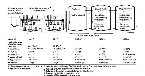
Abb. 12 Aerob-thermophile Teilfermentation mit anschliessender Faulung, System Nebiker
