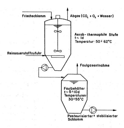
Abb. 9 Aerob-thermophile Teilfermentation mit anschliessender Faulung, System «Union Carbide Dual Digestion»
