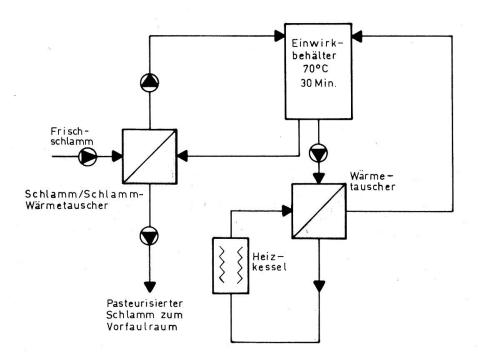
Abb. 4 Thermische Vorpasteurisierung System Sulzer
