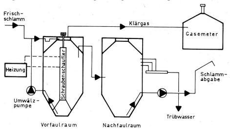
Abb. 1 Schema einer Schlammfaulanlage
