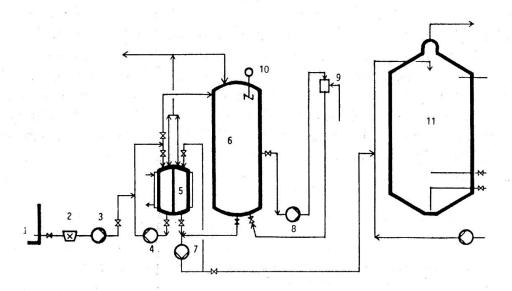
Abb. 10 Aerob-thermophile Teilfermentation mit anschliessender Faulung, System UTB-Aerotherm
