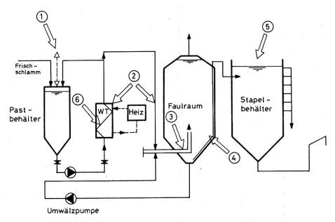
Abb. 7 Schema einer Vorpasteurisierung mit anschliessender Faulung
