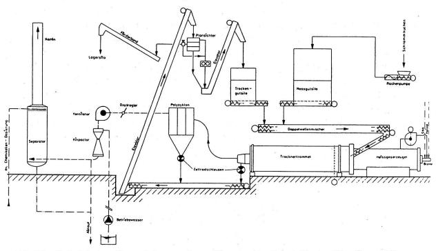
Abb. 15 Beispiel eines Konvektionstrockners (Trommeltrockner) (System Roediger AG)
