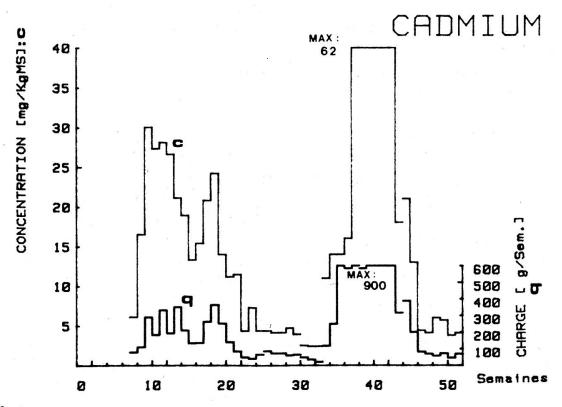
Fig. 3 Profil annuel des concentrations et des charges en cadmium dans les boues digérées [2]
