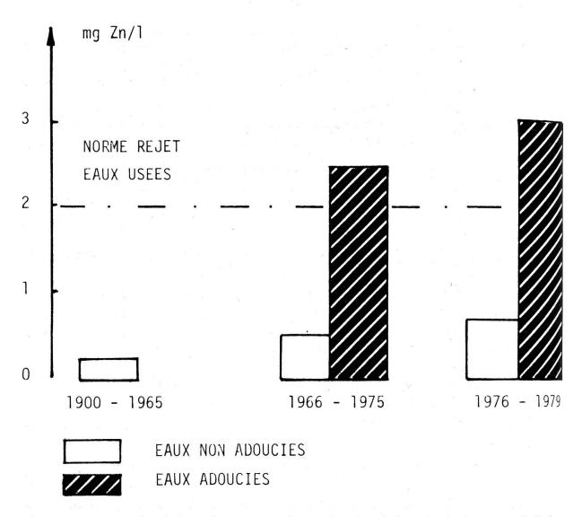
Fig. 5 Teneurs en zinc de l'eau de consommation en fonction de l'âge des bâtiments et de l'adoucissement de l'eau
