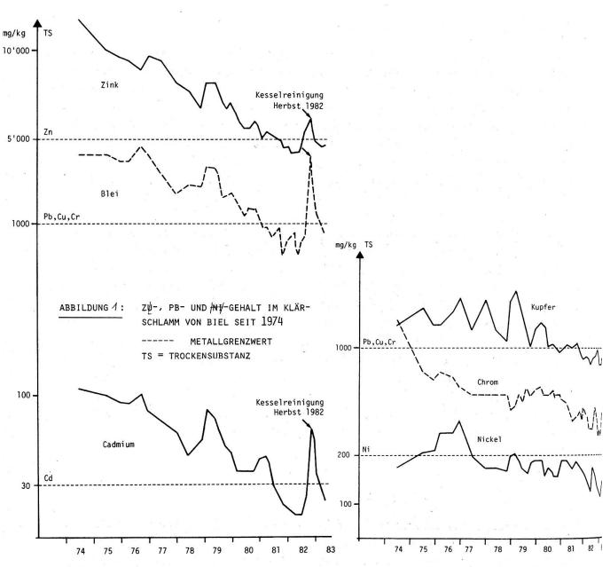
Abb. 1 Zn-, Pb- und Ni-Gehalt im Klärschlamm von Biel seit 1974.
