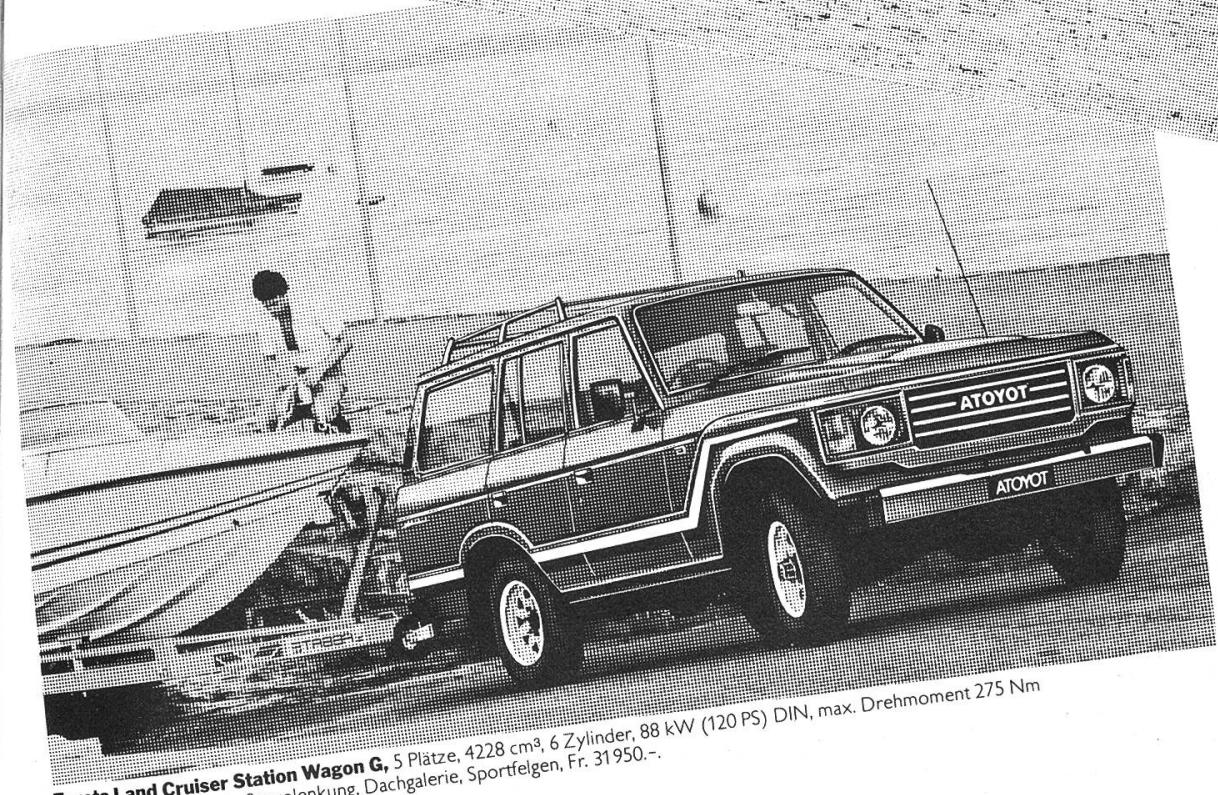
Toyota Land Cruiser Station Wagon G, 5 Plätze, 4228 cm<sup>3</sup>, 6 Zylinder, 88 kW (120 PS) DIN, max. Drehmoment 275 Nm
