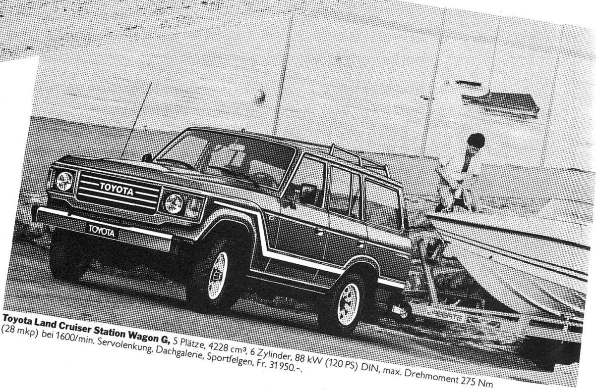
**Toyota Land Cruiser Station Wagon G**, 5 Plätze, 4228 cm<sup>3</sup>, 6 Zylinder, 88 kW (120 PS) DIN, max. Drehmoment 275 Nm
