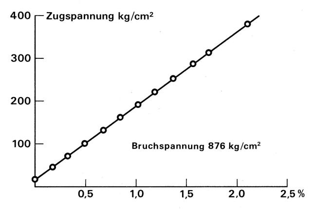
Abb. 2 Zugkraftdehnungsdiagramm von Holz
