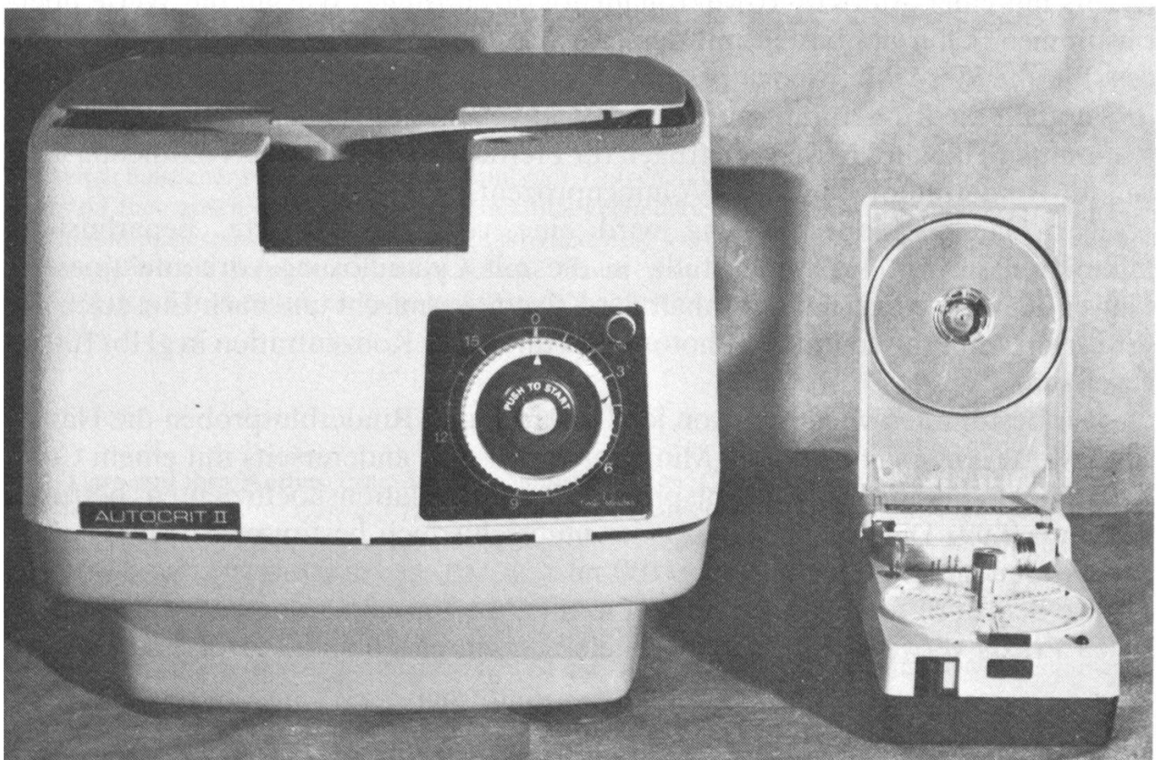
Abb. 2 Mikrohämatokritzentrifuge normaler Bauart links, Minizentrifuge rechts
