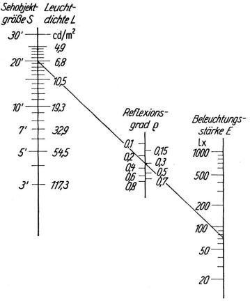
Abb. 1 Nomogramm zur Ermittlung der Belichtungs- und Beleuchtungsstärke [16] Beispiel: S = 20',  $\varrho$  = 0,3 ergibt E = 71 lx
