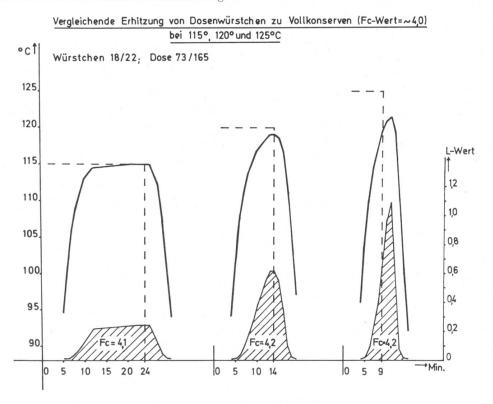
Autoklavtemperatur (linke Kurve) 24 Minuten Einwirkungszeit erforderlich war, mußte man bei 125°C nur 9 Minuten (rechte Kurve) erhitzen, um zum gleichen Sterilisationseffekt zu gelangen. Neben dem ökonomischen Vorteil der intensiveren Nutzung der Maschinen ist die bessere Qualität der kurzzeitig hocherhitzten Würstchen überzeugend.
