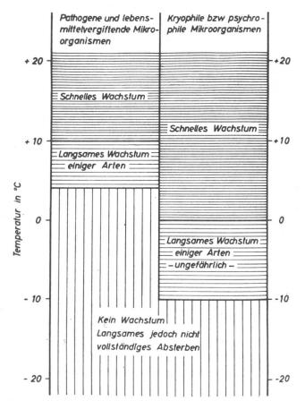
Abb. 4: Wachstumsgrenzen von Mikroorganismen bei sinkender Temperatur (nach GUTSCHMIDT 1964)
