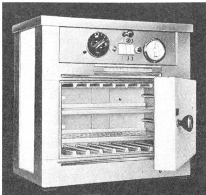
**Brutapparat + Trocken-Sterilisator**
