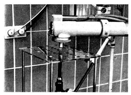
Abb. 1 Versuchsanordnung. Meßplatte mit aufgesetztem Bestrahlungsgerät (RT 100) und Ionisationskammer (XL 37483) darunter.
