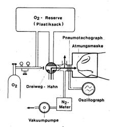
Abb. 4 Vorrichtung für den  $N_2$ -Auswaschungs- und  $N_2$ -Einwaschungstest. In der Abbildung ist der Dreiweghahn für die Atmung von Atmosphärenluft eingestellt. Für die pulmonale  $N_2$ -Auswaschung wird der Dreiweghahn so gedreht, daß das zu untersuchende Tier reinen  $O_2$  aus dem Plastiksack atmet. Weitere Erklärungen im Text.
