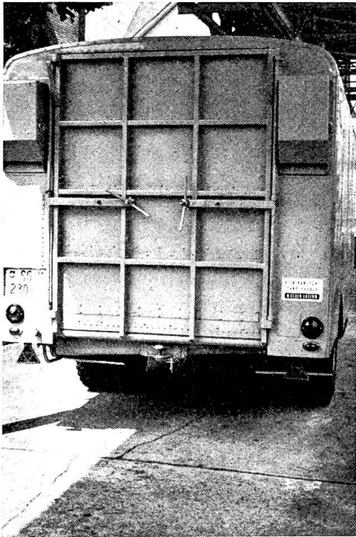
Abb. 2 Kombinierte Ventilator- und Filteranlagen in der Rückwand des Anhängers.
