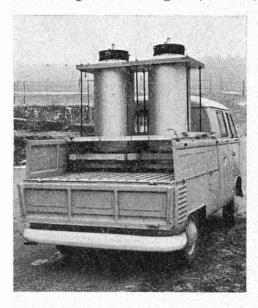
Abb. 3 Lieferwagen mit zwei Druckbehältern zu 1101 bzw. 160 l für die Versorgung der Außenstellen mit flüssigem Stickstoff.
